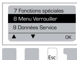
Le "Menu Verrouiller" permet de protéger le Moteur-Régulateur contre toute modification involontaire des paramètres risquant de compromettre les fonctions initiales du Moteur-Régulateur.
