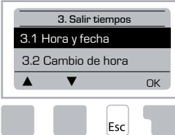
Configuración en el reloj de los tiempos de funcionamiento del circuito de calefacción y agua caliente.
