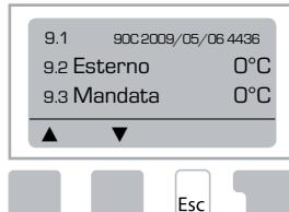
I "dati assistenza" possono essere utilizzati per la diagnosi remota da parte di un tecnico specializzato o del produttore in caso di un errore ecc.
