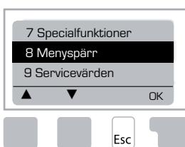
Menyপার্ৰen kan användas för att skydda regleringen mot oavsiktlig ändring och eventyrande av grundfunktioner.
